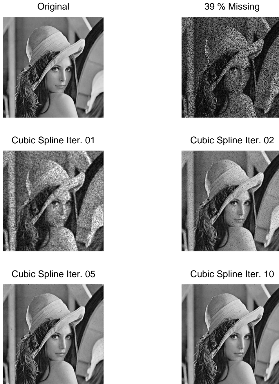
Figura 2: Uma imagem de 512 \times 512 faltando 39 % dos pixels e reconstruções com M_1 = M_2 = 256 e a_1 = a_2 = 2 obtidas usando o método iterativo Gradientes Conjugados. Sistema 158860 \times 65536 .
